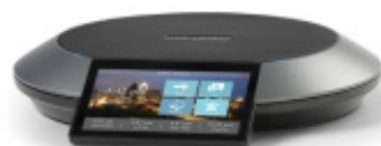
4 en 1 : interface de contrôle, micro, haut-parleur, téléphone IP
