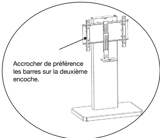
**ÉTAPE 8: Insérer la barre de verrouillage anti-basculement**
