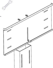
ÉTAPE 4 : Monter le support caméra sur l'accroche de support caméra
